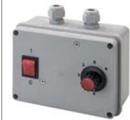
RVS PLUS EVO: 5 sebességállító, on/off kapcsoló. Szabályozás akár 4 POLAR. Max feszültség 1,5 A. IP 42 védelem. Méret 158x118x76 mm.
